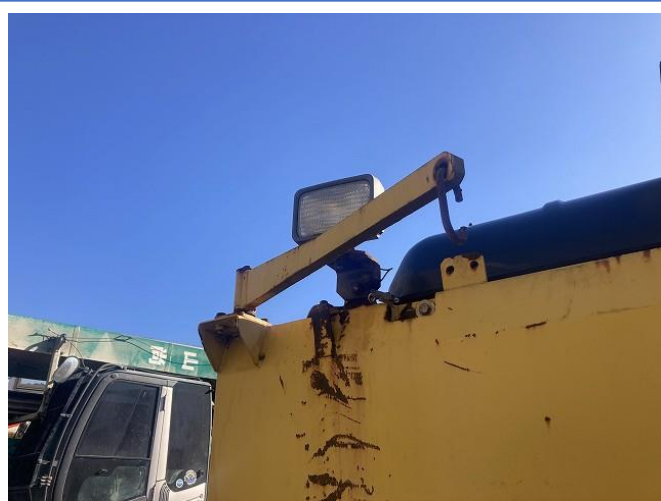
防音カバー欠損
