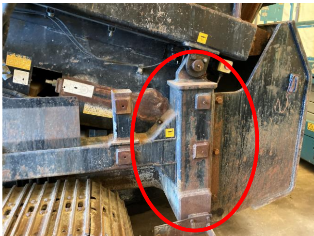
昇降ハシゴ欠損
