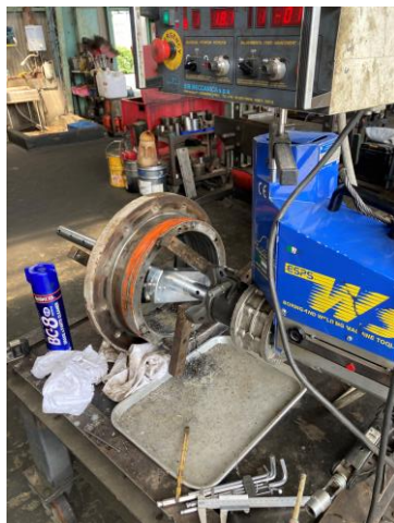
ベアリングケースボーリング加工
