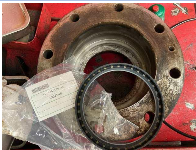
破砕シャフトベアリング両側交換
