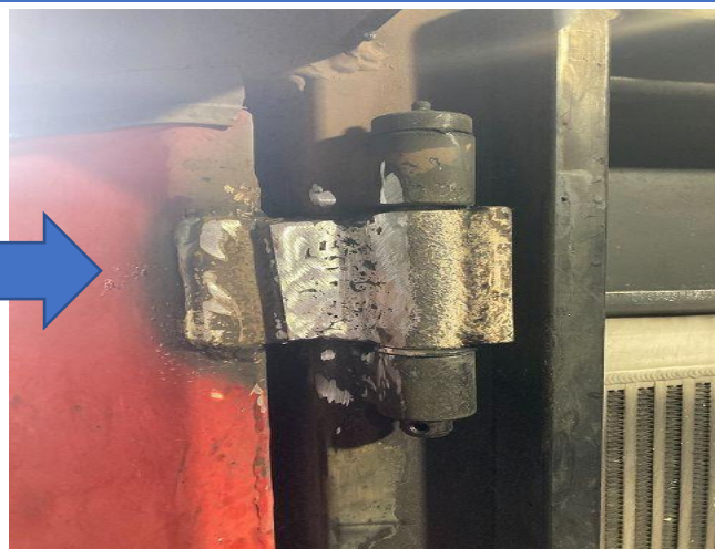
燃料タンク蝶番破損部修正
