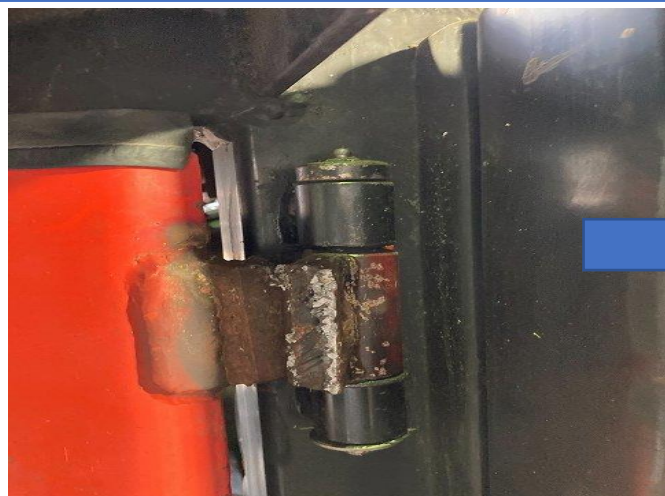
燃料タンク蝶番破損部修正
