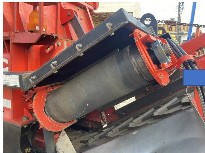
磁選機ゴム劣化損傷の為交換
