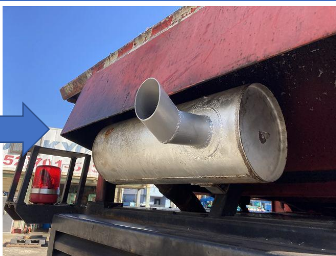
マフラーテールパイプ破損部修正
