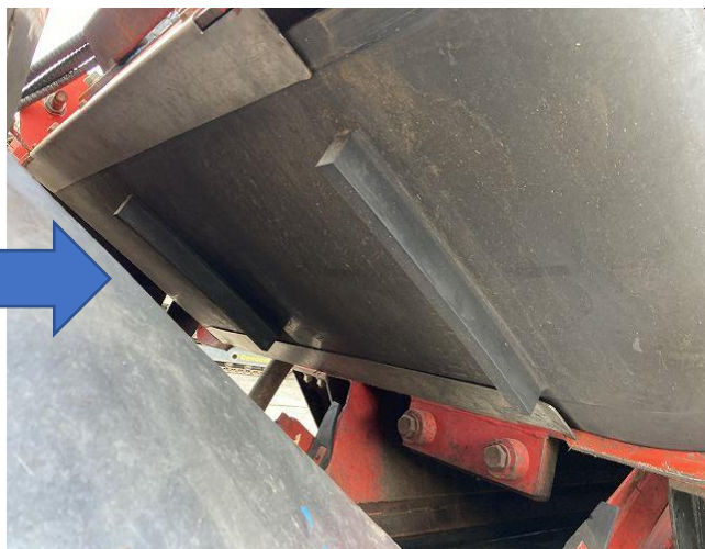
磁選機ゴム劣化損傷の為交換
