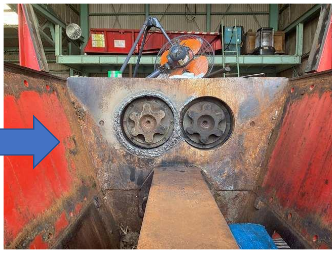
破碎室クローバーシャフトカップリング摩耗の為肉盛り
