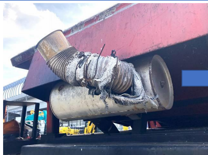
マフラーテールパイプ破損部修正
