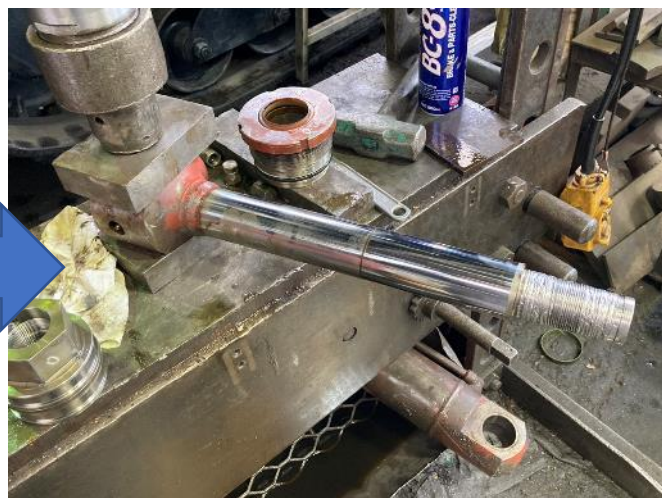
グラップル開閉シリンダー ロッド修正、油漏れ修理（3本）
