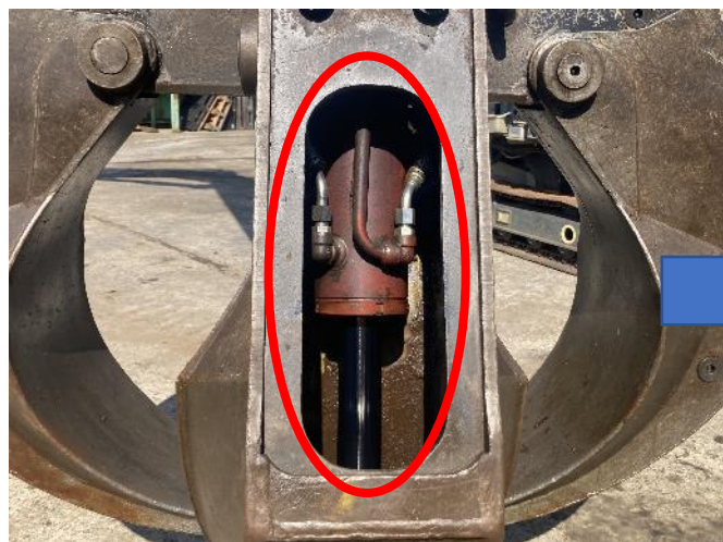
グラップル開閉シリンダー ロッド修正、油漏れ修理（3本）
