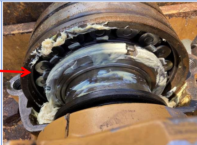
破碎ドラムベアリング両側交換
