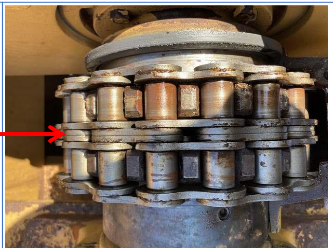
破碎ドラムカップリングチェーン交換
