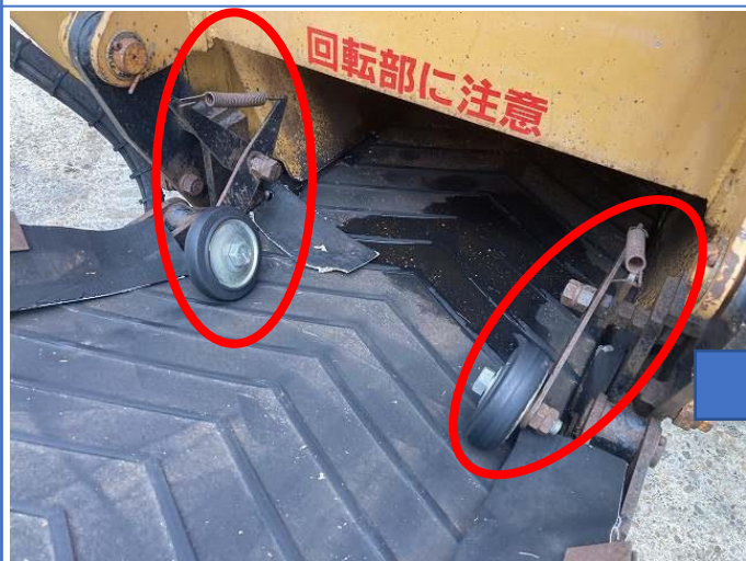
コンベア押さえローラー、スプリング交換
