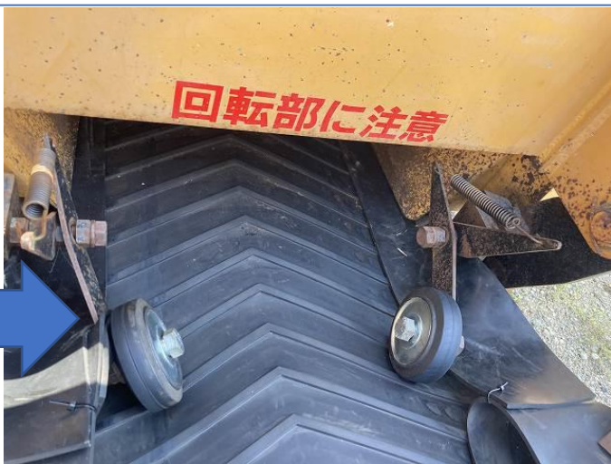
コンベア押さえローラー、スプリング交換
