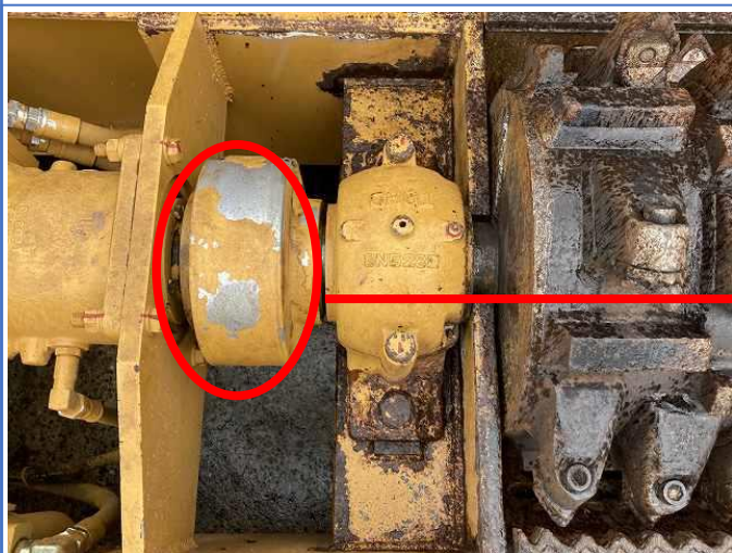
破碎ドラムカップリングチェーン交換
