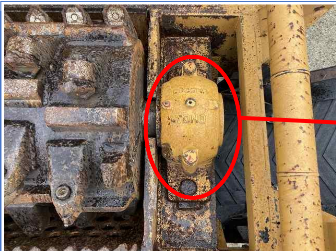
破碎ドラムベアリング両側交換
