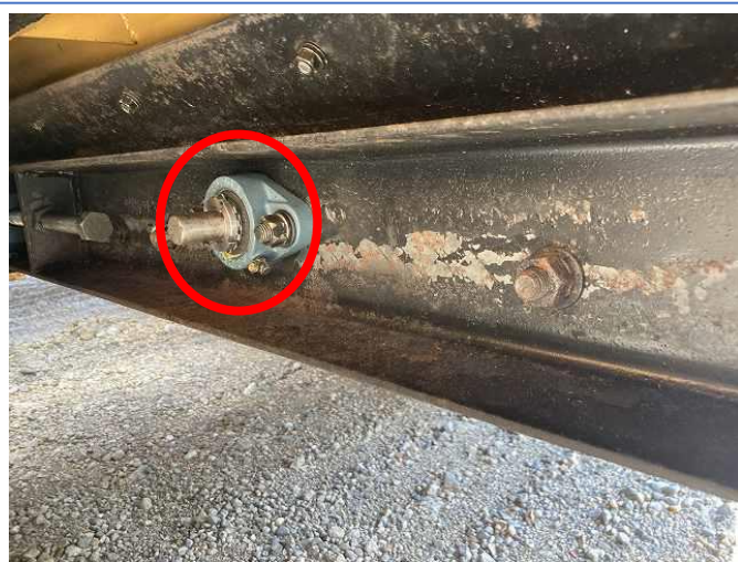
コンベアガイドローラーベアリング、テールプーリーベアリング交換
