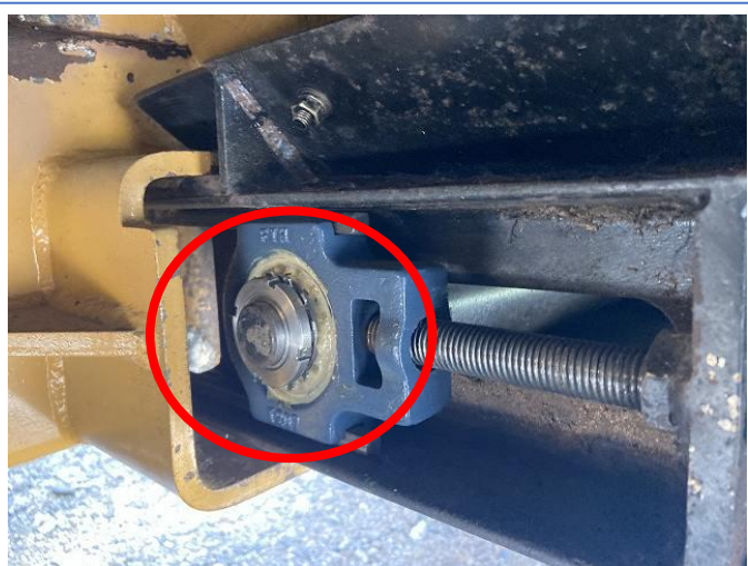
コンベアガイドローラーベアリング、テールプーリーベアリング交換
