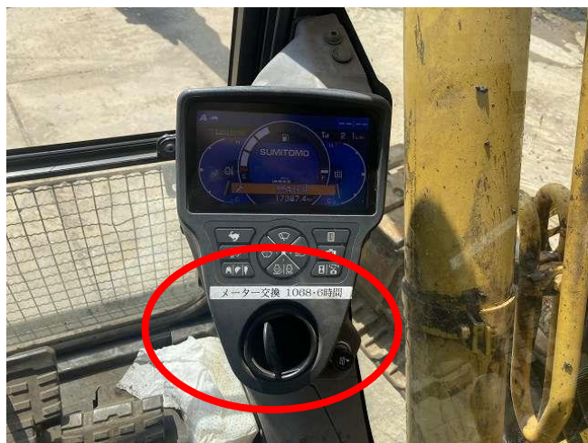
エアコンルーバー破損
