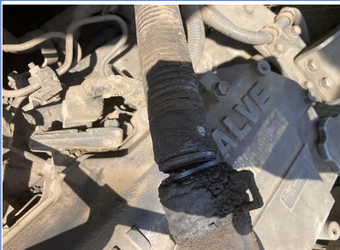
ブローバイホース断裂
