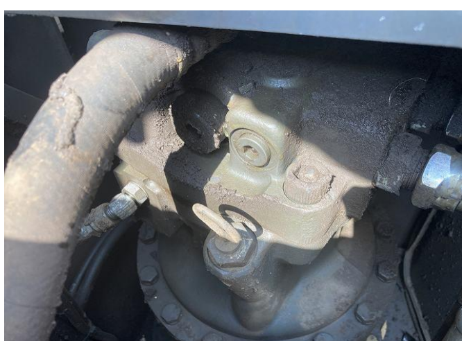
旋回モーター油漏れ（小）
