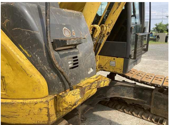
本体昇降ステップ付近変形
