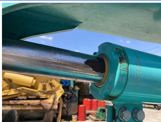
第一ブームシリンダのメッキ剥離
