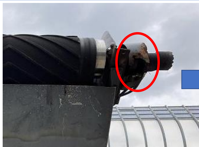
排出コンベア モーターカバー交換
