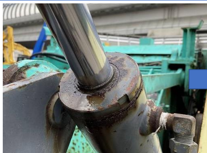
排出コンベア 折畳シリンダー油漏れ修理
