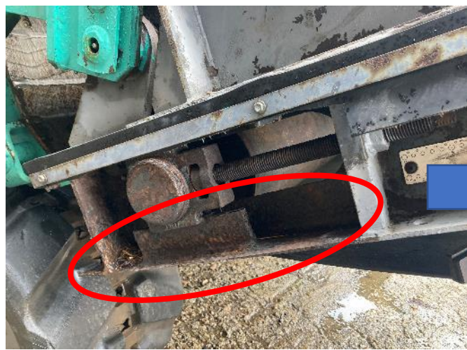
排出コンベアフレーム腐食部補修
