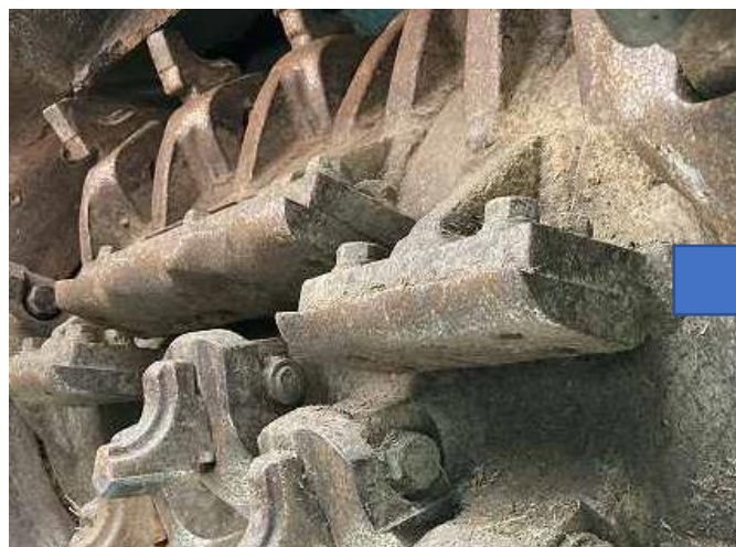
破砕室 ウィングプレート交換
