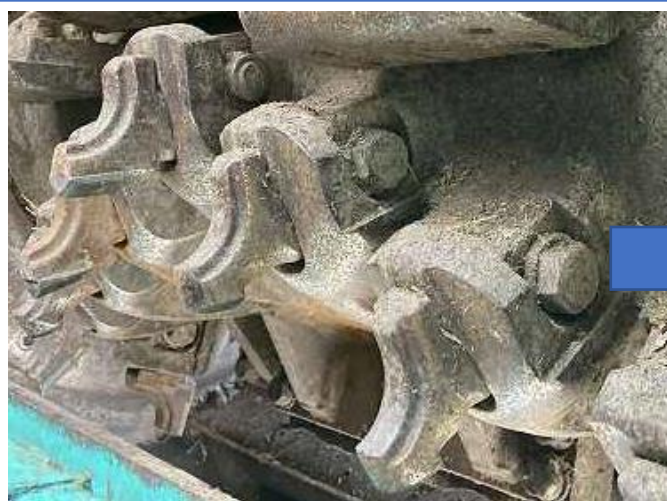
破砕室 破砕ビット交換
